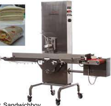
Model 型號 Sandwichboy Capacity 生產量 160 pieces/min Dimension 尺寸 1950x650x1840 WxDxH(mm) Electricals 電源 400/3/50, 3kW
