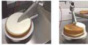
Model 型號 Belcake 1340 Capacity 生產量 150 cakes/h Dimension 尺寸 1370x720x2003 WxDxH(mm)
