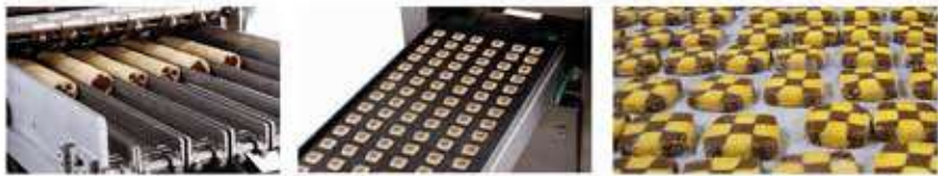
Model 型號 Sandwichboy Capacity 生產量 160 pieces/min Dimension 尺寸 1950x650x1840 WxDxH(mm) Electricals 電源 400/3/50, 3kW
